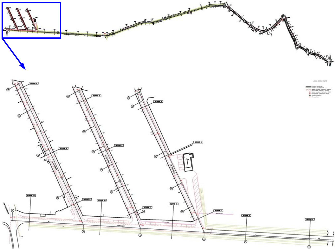
Figura 1. Tratto di via Galli interessato dalla realizzazione della fognatura (sopra il quadro d'insieme della via).
